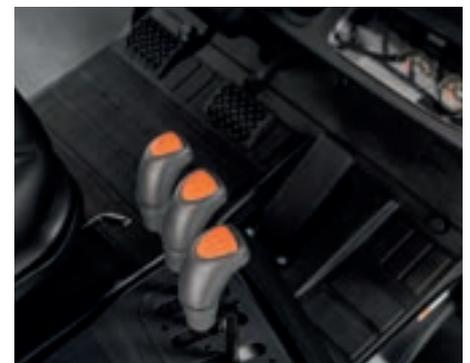
Einfache Steuerung mit Pedalen wie im Auto – großes Gaspedal, Inchpedal und druckluftbetriebene Bremse. Dank der federbetätigten Feststellbremse können Sie auch bei ausgeschaltetem Motor mühelos bremsen.
