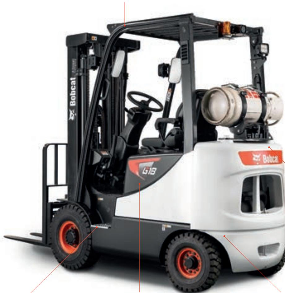
Für maximale Sicherheit verhindert das Bedienererkennungssystem (OSS) ungewollte Bewegungen des Staplers, wenn der Bediener den Sitz verlässt
