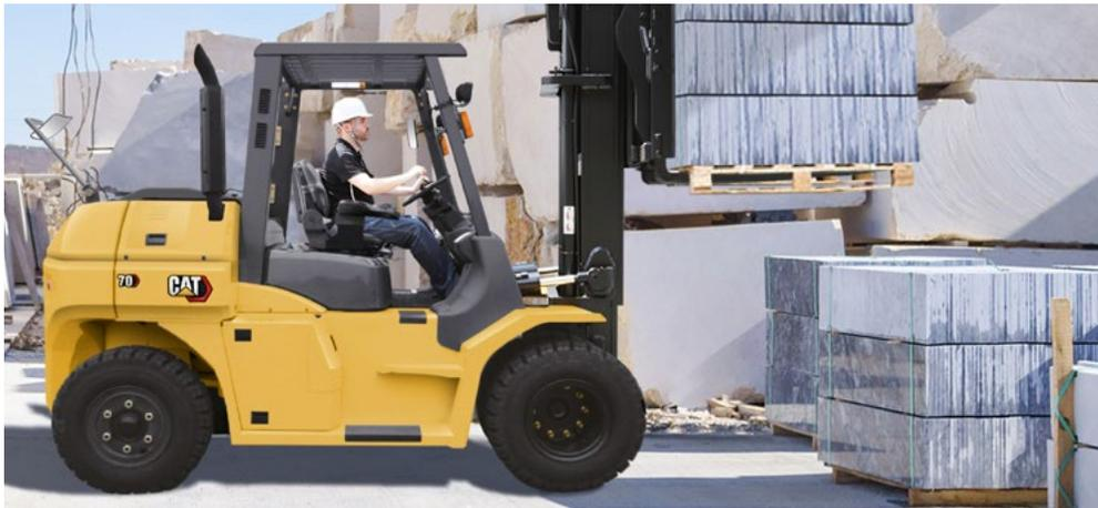
Sein 3,8-Liter-Common-Rail-Dieselmotor liefert hohe Leistung bei minimaler Vibrationsübertragung auf den Fahrersitz, was der Verwendung von Dämpfungsmaterialien zwischen Rahmen und Motor zu verdanken ist.
