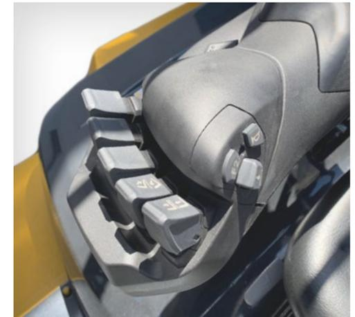
Die optionale verstellbare Armlehne kombiniert anatomische Unterstützung mit Bewegungsfreiheit und perfekter Handpositionierung und ist mit einer federkraftoptimierten hydraulischen Fingertip-Steuerung ausgestattet.
