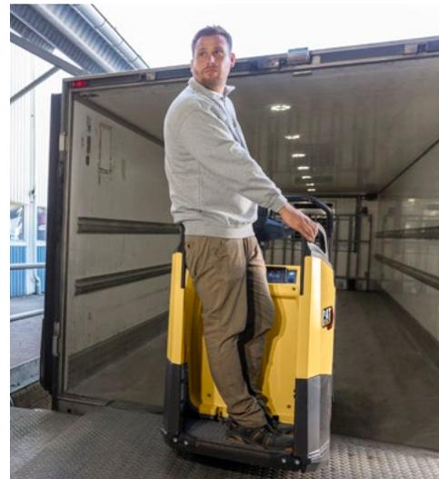
Die Versionen NPF20N3R und NPF25N3R mit fester Plattform und Einstieg von hinten bilden die perfekte Wahl für Be- und Entladearbeiten. Für noch mehr Sicherheit bieten sie wahlweise das automatische Abbremsen/Anhalten, sobald sich ein Fuß des Bedieners außerhalb der Plattform befindet.
