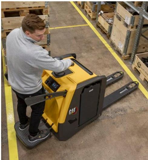
Modelle mit klappbarer oder fester Plattform, Traglasten von 2,0 oder 2,5 Tonnen und drei verschiedenen Fahrwerkslängen stehen zur Auswahl. Außerdem können sie wahlweise mit Lithium-Ionen- oder Blei-Säure-Akkus ausgestattet werden. Die Versionen NPV20N3 und NPV25N3 mit klappbarer Plattform verfügen über aus- und einklappbare Seitenschutzbügel.
