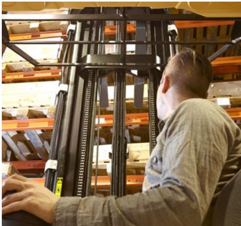
Mit den in sein Profil integrierten Hydraulikzylindern ist der PoweRamic-Mast stabiler und schmäler und bietet bessere Sicht als herkömmliche Konstruktionen. Alle Bewegungen des Staplers und seiner Mastbaugruppe werden dank des Responsive Drive System (RDS) gleichmäßig und präzise gesteuert.
