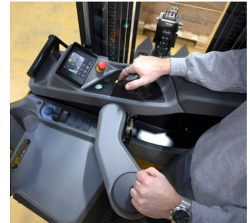
Die ergonomischen Bedienelemente sorgen für weiteren Komfort, Jobzufriedenheit und Produktivität - und vermeiden Stress, Belastung und Ermüdung. Sie beinhalten eine voll verstellbare (auf-/ab-, vor-/rückwärts) Lenkkonsole, die eine perfekte Fahrerposition ermöglicht, und die in der Armlehne angeordneten Features für die simultane Steuerung der Fahr- und Hydraulikfunktionen.
